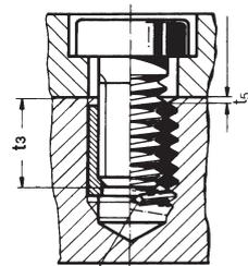
Avant de tarauder, assurez-vous qu'il y a un chanfrein à 90° et qu'il n'y a pas de bavures. Diamètre extérieur du **chanfrein** =  $D_{HC} + 0.1 \text{ mm}$ .
